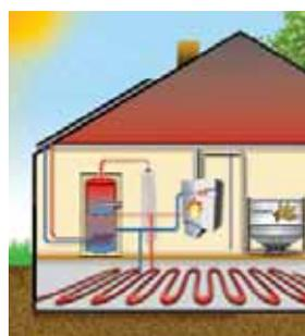
Esquema caldera Therm de pellets mural, suministrando calefacción por suelo radiante y ACS con el apoyo de un sistema solar. La caldera se alimenta de pellets de un interior (BOX) en el interior de la vivienda.
