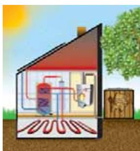
Esquema caldera Therm de pellets mural, suministrando calefacción por suelo radiante y ACS con el apoyo de un sistema solar. La caldera se alimenta de pellets de un silo exterior (TOP) al aire libre.
