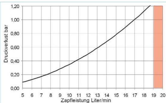
Pérdidas de presión sin limitador de la cantidad del agua fría. Con limitador de la cantidad del agua fría la pérdida de presión sube por ca. 0,3 hasta 0,4 bar con carga máx..
